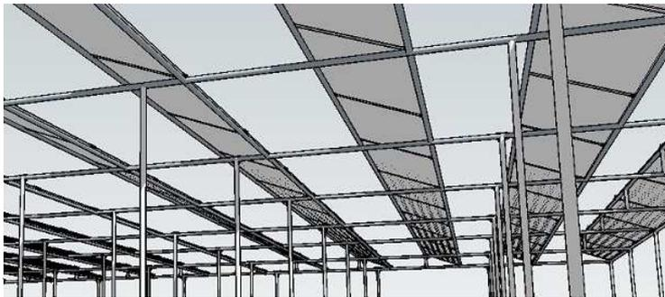
頭上に並ぶ太陽光パネルは太陽光を農地に降らせることが出来るように隙間を設けています。
